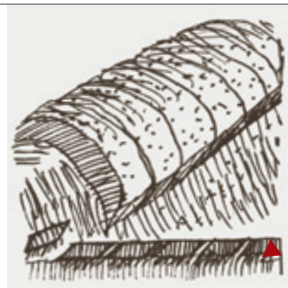
Mønningstørvene skal skæres af kraftige engtørø med en længde på ca. 1,2 m og med et trapezformet tværsnit.
