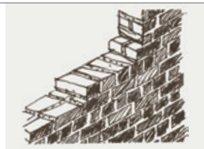
Krydsforbandt i fuldmur Løberskifte/Kopskifte (bindere) Binderne går på tværs og 'låser' murværket.
